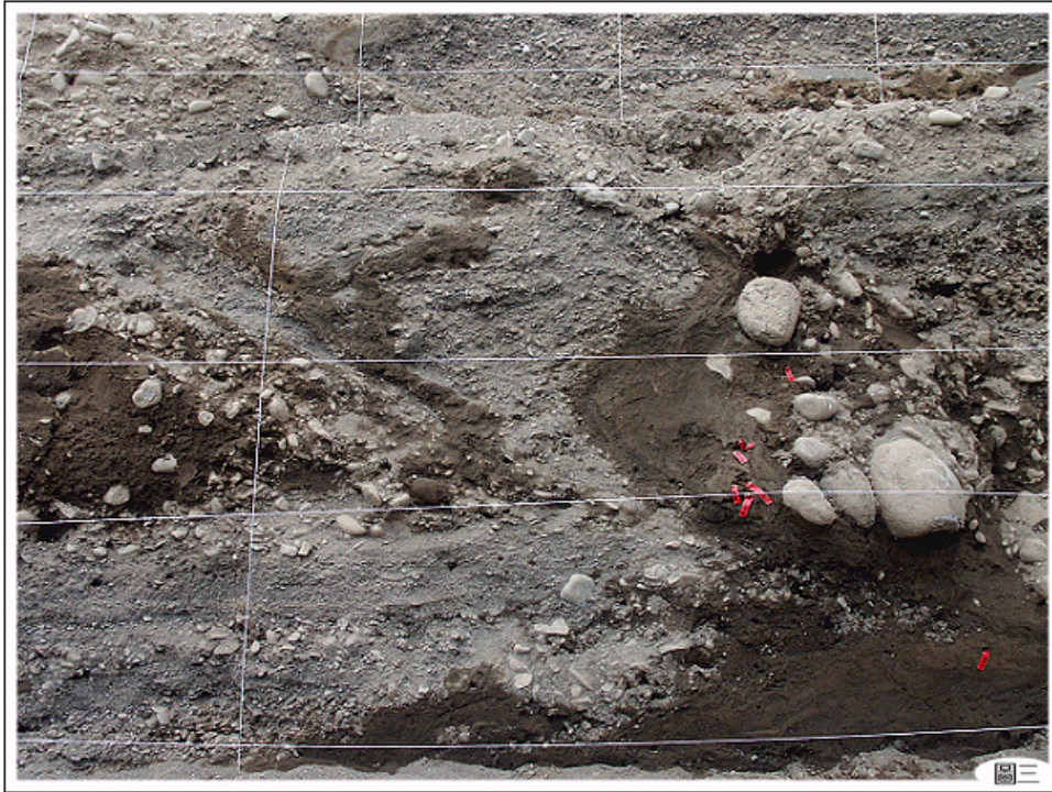
圖三、南牆第二階的斷層與近斷層的褶皺構造。
