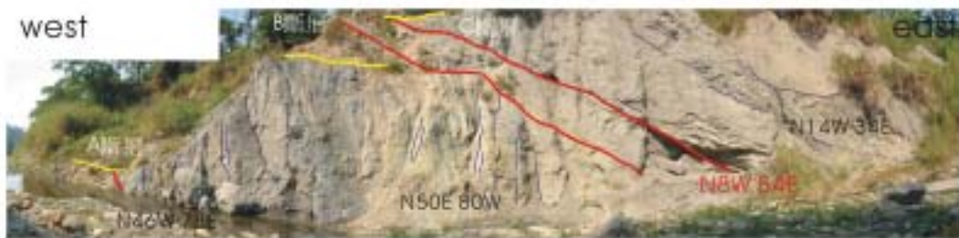
圖六 大湖口溪北岸剖面的 A,B,C 斷層都截切下盤的晚更新世 - 全新世的紅土階地砂礫層與階地礫石層，顯示近期曾有活動。
