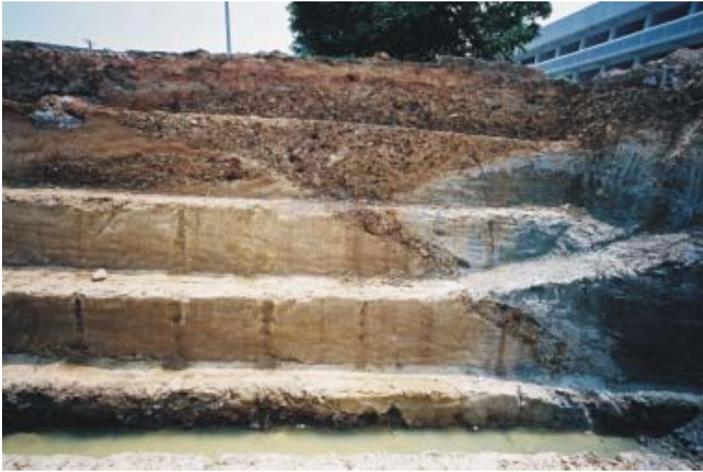
圖二 1 號槽溝北牆的斷層帶,共有 5 階,卓蘭層逆衝到晚更新世的河流相砂礫層之上(洪如江教授攝)。
