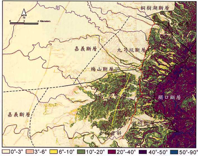
圖二 九芎坑斷層上盤地形坡度約在15-35度之間，下盤地形坡度約20度以下，而觸口斷層上盤地形坡度則大於25度。
