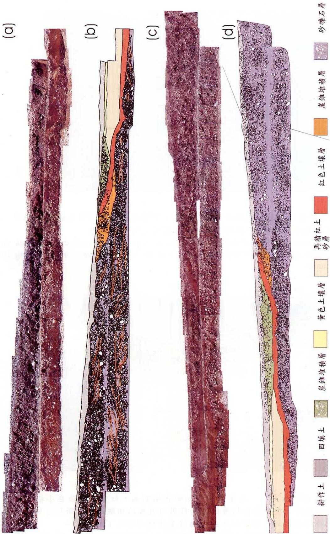
圖六 梅山斷層2號槽溝剖面，a、b為西牆剖面，c、d為東牆剖面。
